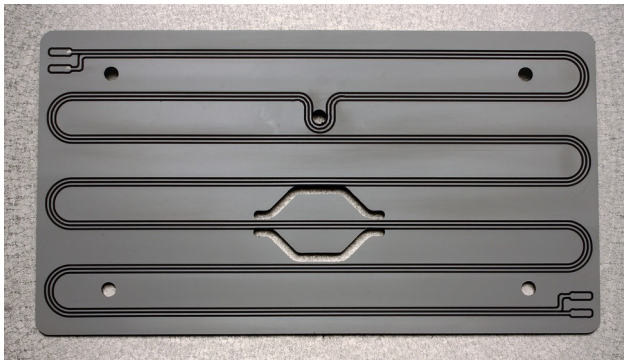
Verbundstoff mit isoliergefrästen Leiterbahnen zur Überwachung von Oberflächen im Innen- und Außenbereich vor Durchbruch und Sabotage.
